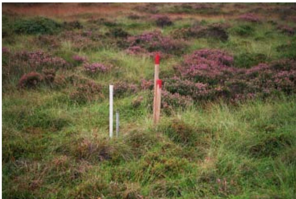
Figur 5.3 Vandstanden registreres i pejlerør og i forhold til et nedrammet stålrør som fikspunkt i den centrale højmoseflade.
